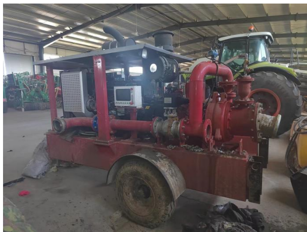
泵送式管道施肥机自动化泵组
