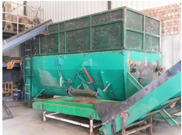
进口集装箱式粪污处理系统及出料暂存槽
