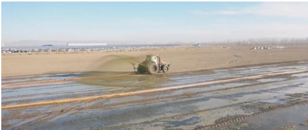
泵送式管道施肥机液肥施用作业
