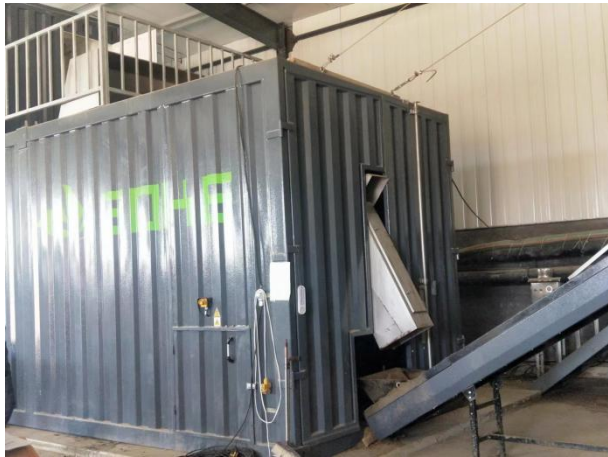
进口集装箱式粪污处理系统及出料暂存槽
